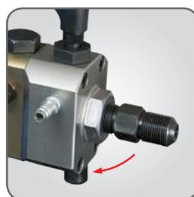
Если соединенные поверхности не повреждены, затяните соединение.
