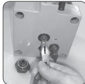
Если пневматический мотор работает слишком шумно и пропускает воздух, это свидетельствует о слишком высоком давлении подачи воздуха на THAP...E.
