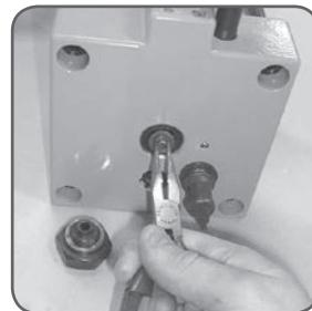
Se o motor a ar estiver excessivamente barulhento e vazando ar, a pressão de ar fornecida à série THAP...E estará muito alta. O limitador de ar embutido não permitirá a utilização de pressões de ar acima de 7 bar (100 psi). Reduza a pressão de ar para 7 bar (100 psi).
